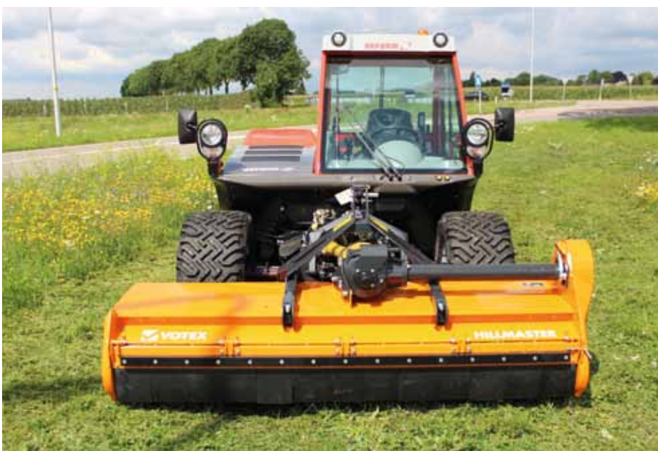
De Votex Hillmaster 220 heeft zowel een hydraulische als een mechanische bok.
