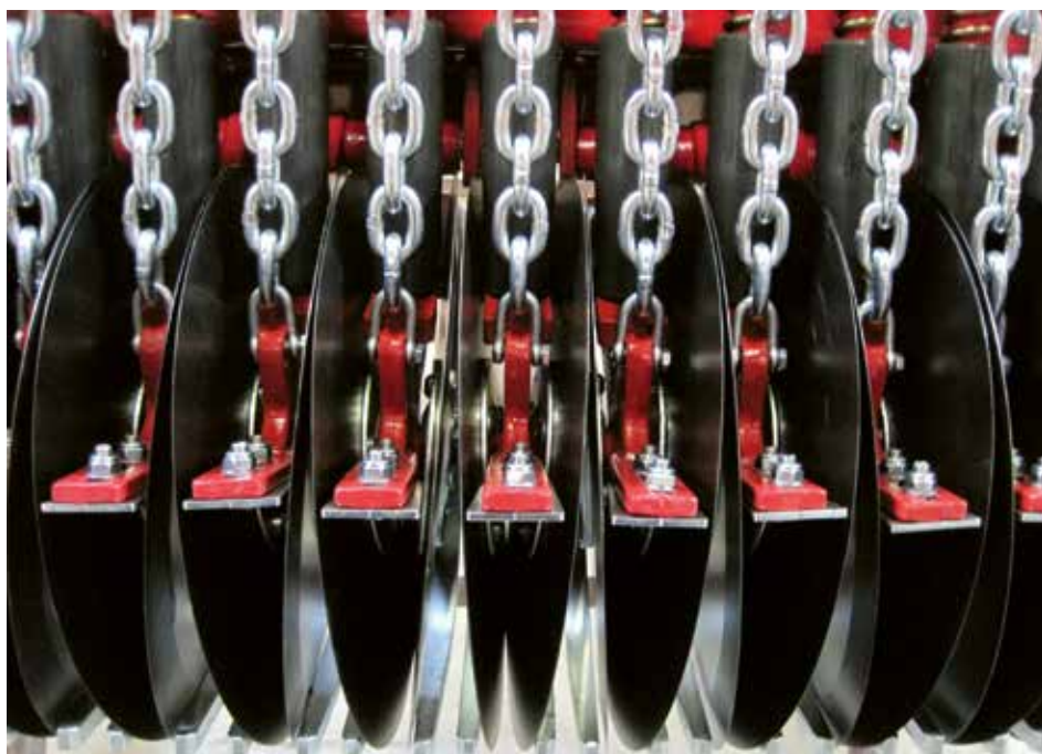
De double disc-doorzaaiers hebben een onderlinge groefafstand van slechts 3 cm, minder dan bij enige andere doorzaaiers.
