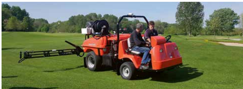
Smithco's zelfrijdende spuit Spraystar, met pulserende nozzles en gps-spuitsysteem
