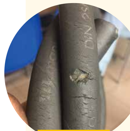
Ernstig beschadigde hydrauliekslang
