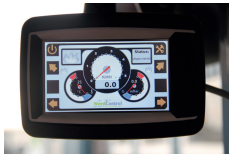
Een PLC met touchscreen
