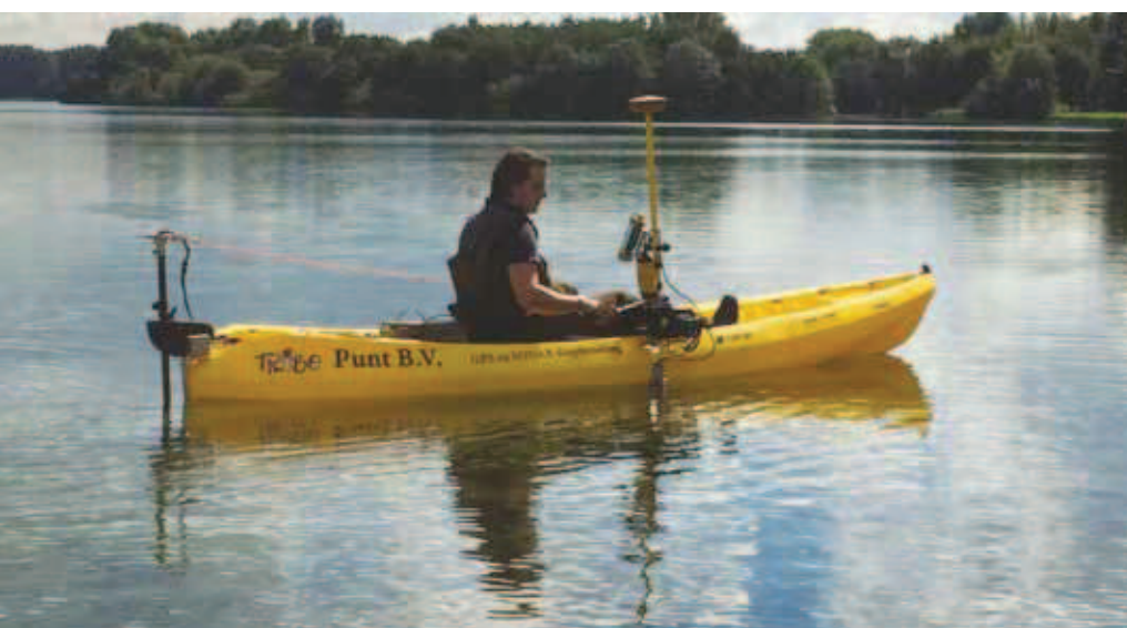
Met een waadpak kun je maximaal 400 meetpunten per dag meten; met de kano al gauw 18.000.
