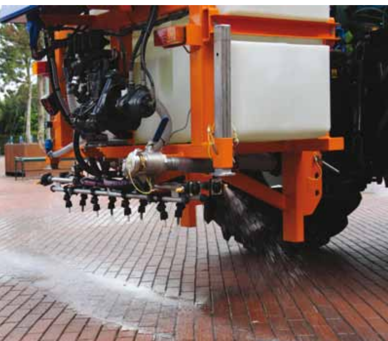
De Nido CSP spuit maximaal 3,40 m breed dankzij de gele breedspuitdoppen. Op de foto is goed te zien dat alleen de voorste spuitleiding gebruikt wordt (grijze doppen).
