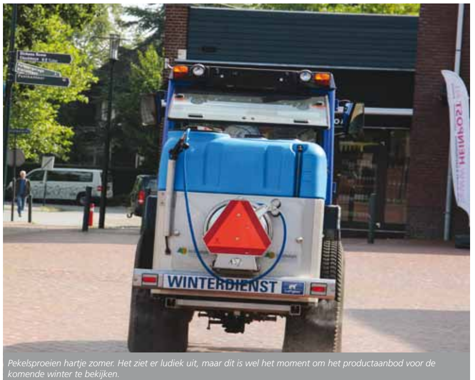
Ook bij Nido zit de peilbuis achterop. Handig bij het vullen, maar niet tijdens het werk. De peilbuis rechtsvoor plaatsen was bij beide machines handiger geweest.
