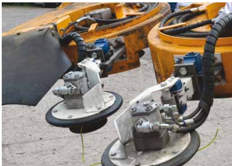
Met twee van deze Clean Mower gemonteerd op een Unimog kan voortaan in één werkgang zowel voor, achter als onder de vangrail gemaaid worden.
