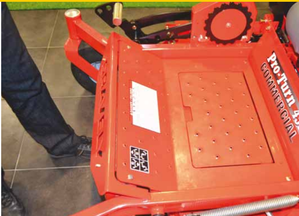
Trillingsdemping: Stalen voetplaats, staat niet in verbinding met hoofdframe.
