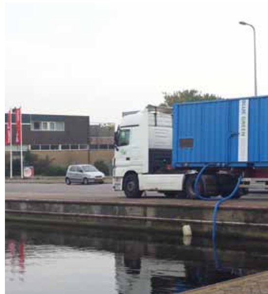
De mobiele biomassa-installatie verwarmt water op locatie.
