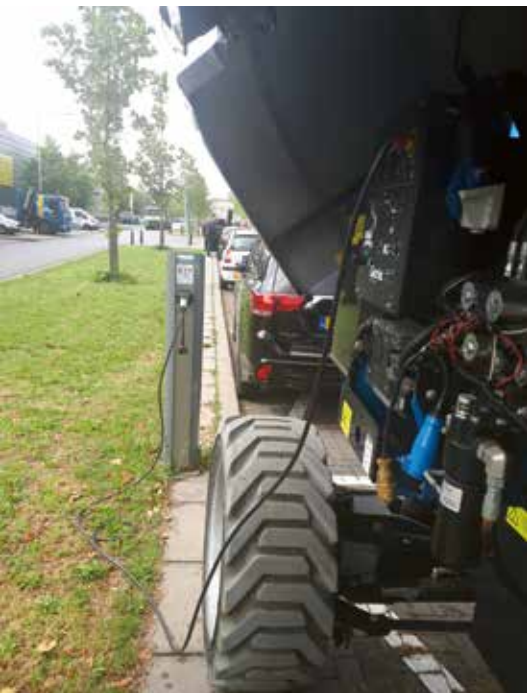
Op locatie in de stad 230 V 'tanken' vanaf een standaard krachtstroomlaadpaal met niets meer dan een aangepaste stekker
