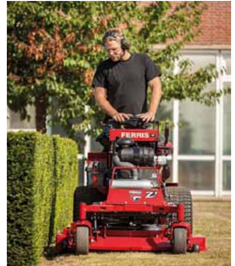
De stand-on Ferris-maaier heeft een werkbreedte van 91 cm en is mede zo smal door de achteruitworp van het afgemaaide gras.
