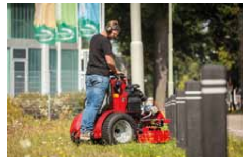
Door de automatische stop van de maaier terwijl de motor blijft draaien, kan de bestuurder makkelijk objecten, zoals afval, van de grond oprapen, of even afstappen om een poortje te openen of te sluiten.
