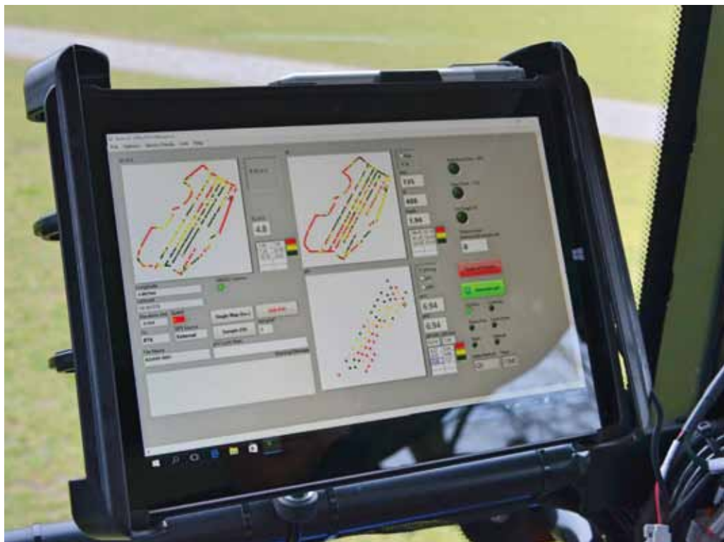
Het linkerdisplay is van de gps-besturing; op het rechterdisplay worden de scandata opgeslagen.
