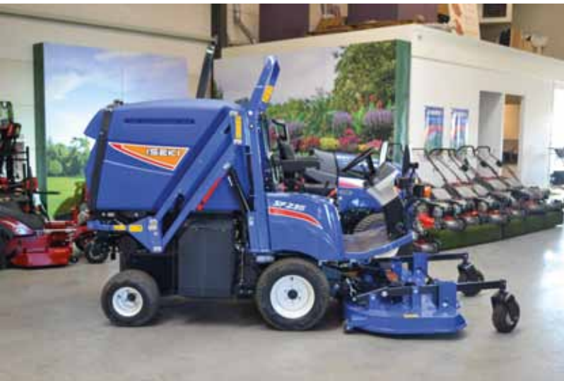
De opvangbak heeft een kiephoogte van ruim 2 m.
