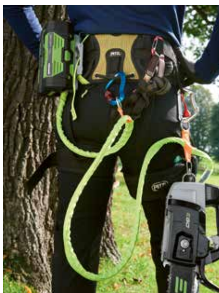
Foto: 6. Tophendelzaag met zaagstrop
