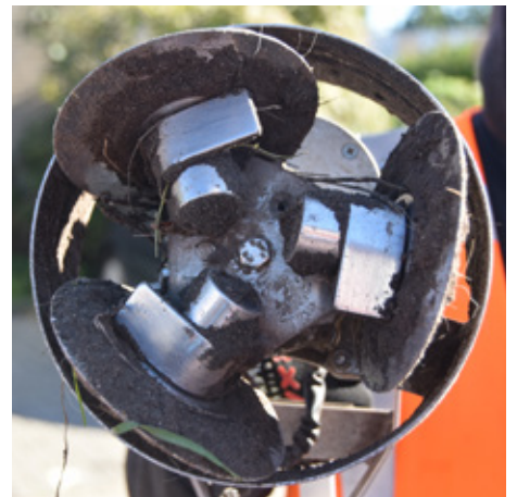
De Houtec werkt met draaiende rvs schijven die op pizzamesen lijken.
