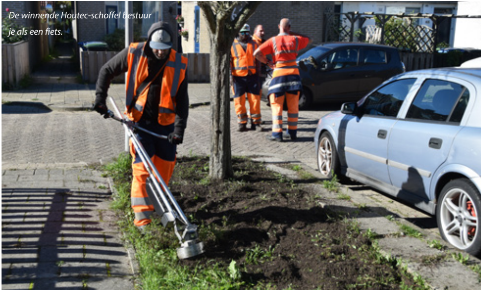
Het Prontec-opzetstuk voor de Stihl-combimachine heeft verticaal geplaatste messen.
