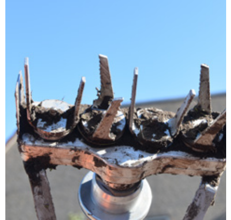
Het Prontec-opzetstuk voor de Stihl-combimachine heeft verticaal geplaatste messen.
