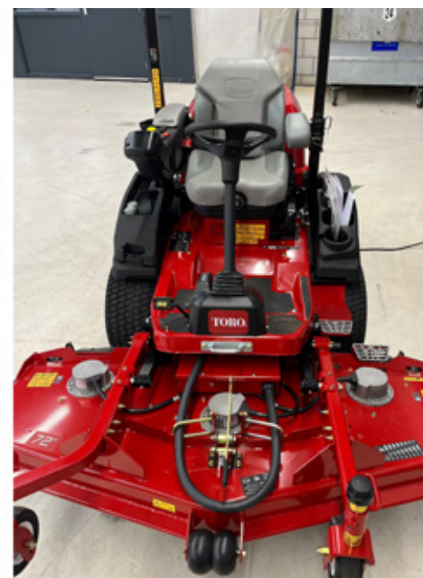
Links: Overzichtelijke bedieningsconsole. Rechts: Een maaidek van 152 of 183 centimeter breedte
