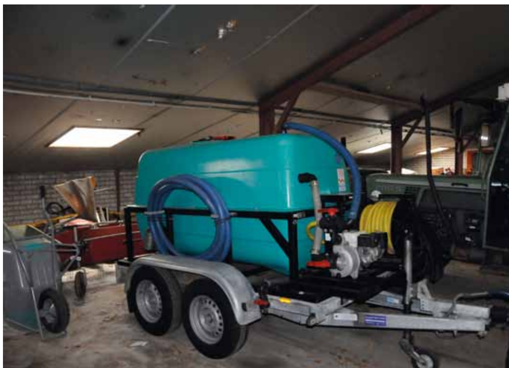
Een slimme eigen ontwikkeling: In de zomer bomen water geven en in de winter gladheidsbestrijding met pekkel.
