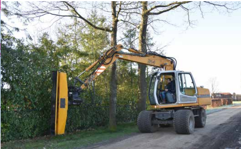
Twee maaimessen en vier mulchmessen per rotor.
