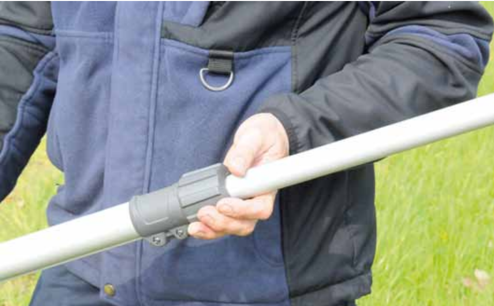
Door het losdraaien van een wartel kun je de steel makkelijk uitschuiven.
