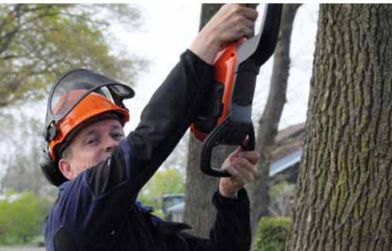
Baltes: 'Met de machine kun je ook makkelijk takken met een diameter van meer dan 25 cm doorsagen. Eerst aan de onderkant insagen, dan aan de bovenkant ruim van de stam wegzagen en daarna voor een nette afwerking het laatste stompje afzagen.'
