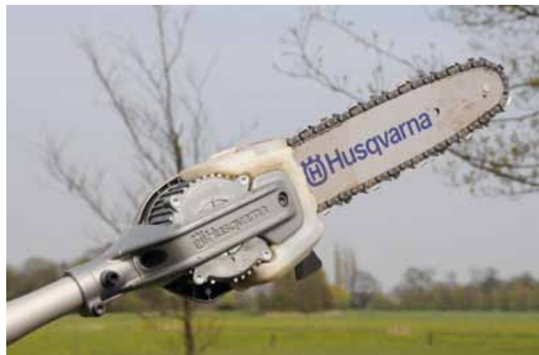
De kop van de machine: lengte zaagblad 25 cm, kettingsnelheid van 20 m/sec.
