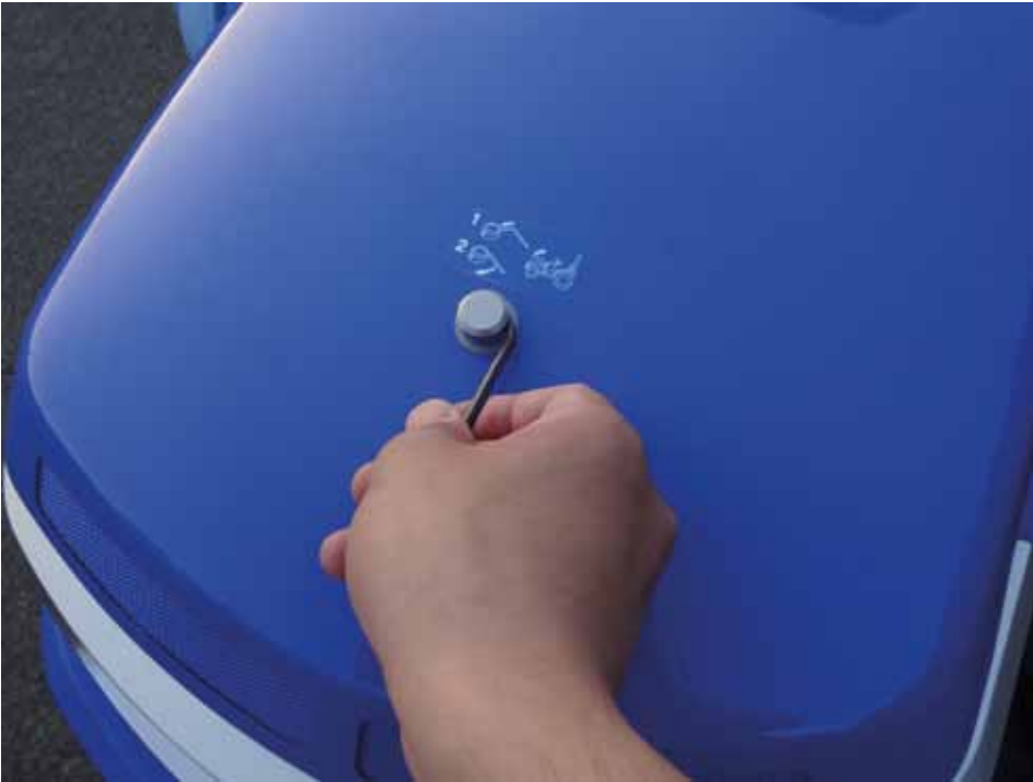
Motorkapbeveiliging: de motorkap mag alleen met gereedschap of sleutel te openen zijn.
