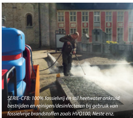
De SteamPLUS® hogedruk-stoomtechniek met een werkdruk tot 250 bar, een stabiele temperatuur van 150 °C aan de nozzle en een stoomvolume van maar liefst 17.000 liter per minuut levert uitzonderlijke reinigingsprestaties zonder gebruik te maken van chemie en zonder beschadiging van de ondergrond.
