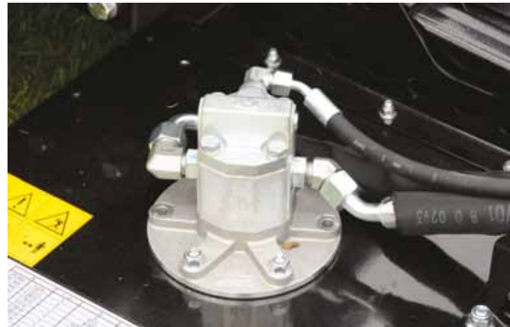
De hydromotoren zijn direct op snijmesses gemonteerd
