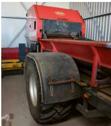
Tolenaars gebruikte voor de ontwikkelde machine een rollenpers van een Vicon.
