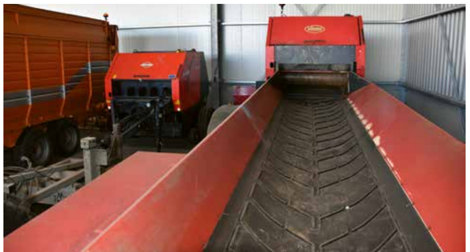
Een transportband voert de natte biomassa naar de rollenpers.
