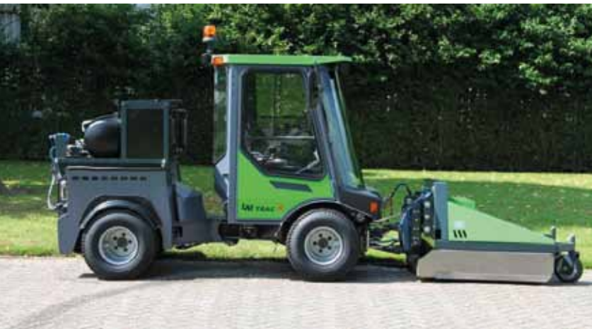
De HOAF Weedair wordt gevoed door een gasfles achter op de drager.
