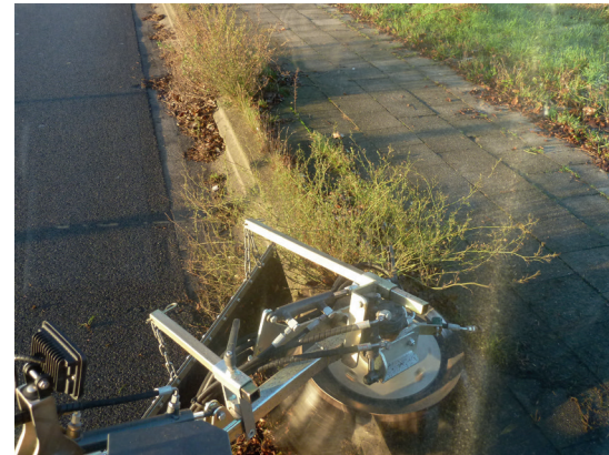
Door het gewicht van de borstel kan de machine onkruid van elk formaat aan.
