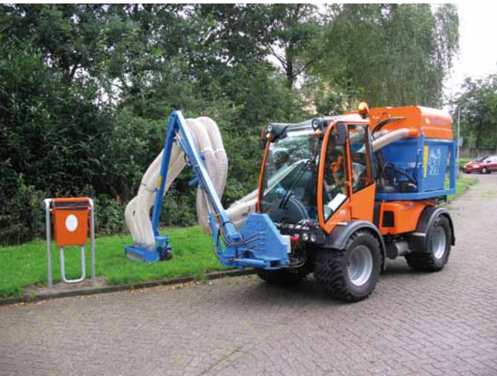
De hondenpoepzuiger heeft een lange arm, waarmee hij een grote oppervlakte kan reinigen.
