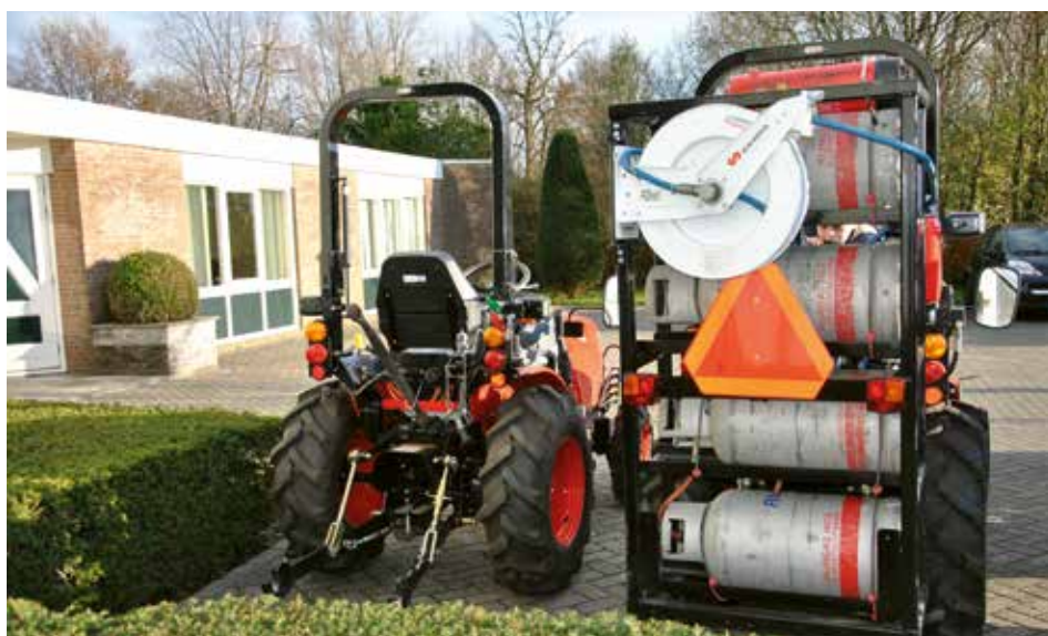
De aan Mennega geleverde combinatie Branson 2505H met onkruidbrander en gasflessenrek
