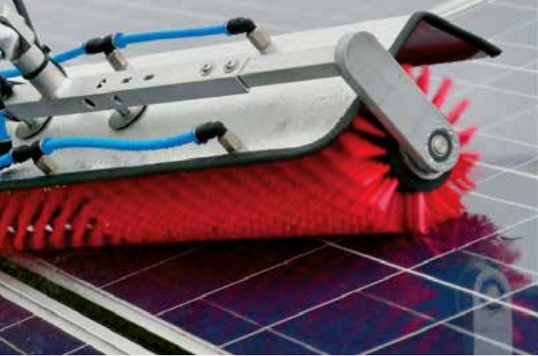
Naast de reinigingsrobot Solar Cleano type F1 worden verschillende types borstels ingezet, met gebruikmaking van osmosewater.
