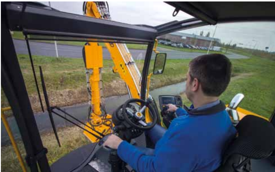
Door de meedraaiende cabine heeft de bestuurder maximaal overzicht.
