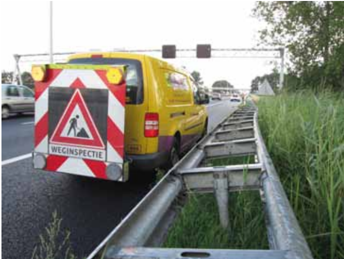
Actieraam met waarschuwingslichten trekt de aandacht van achteropkomend verkeer.
